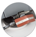
Sistema de protectores contra salpicaduras laterales elevable
