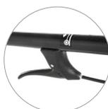
Palanca de activación de la tracción mecánica
