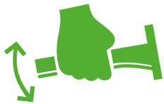
Le levier central permet, le cas échéant, de déplacer facilement la machine d'une main le cas échéant : il suffit d'appuyer sur le levier central et la grosse poignée se « décroche » et se baisse en permettant à ROLLY NRG 7 ½ M 33 de se déplacer même sous les tables et les chaises ;
