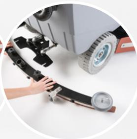
Fácil acceso al cabezal: instalación y desmontaje de los cepillos simplificado.
