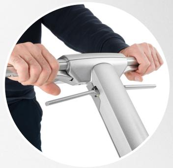
Sicherheitshebel zum Abschalten aller Maschinenfunktionen, wenn der Bediener loslässt. Maximale Sicherheit auch bei plötzlichem Anhalten.
