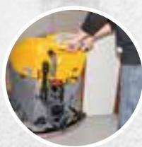
Регулируемая и компактная всасывающая балка
