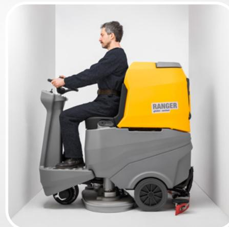
Sans pareil dans le nettoyage au ras du mur, grâce à la rétraction automatique de la tête et du système d'essuyage en cas de chocs accidentels, elle se déplace sans aucun problème même dans les endroits les plus difficiles.
