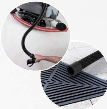
Быстрое опорожнение бака грязной воды
