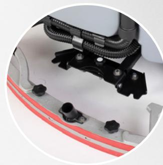
Le système d'essuyage s'accroche et se décroche facilement grâce à deux manettes, sans utiliser aucun outil.
