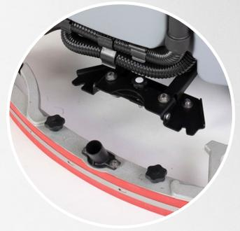
Der Saugbalken lässt sich dank zweier praktischer Knöpfe einfach und ohne Notwendigkeit von Werkzeug an- und abmontieren.
