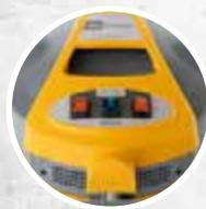
Einschalter (zwei motoren und pumpe)
