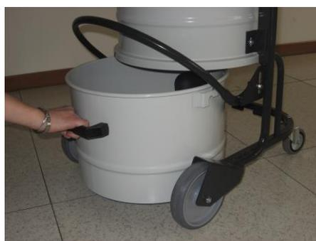
Vider le matériel aspiré présent à l'intérieur de la cuve dans un conteneur approprié, destiné l'élimination des déchets, conformément aux lois en vigueur dans le pays d'utilisation de l'aspirateur.
