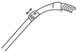
Скользящий блок может перемещаться вверх и вниз для регулировки воздушного потока.
