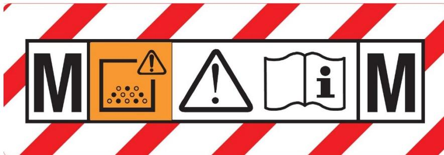
**CLASE M - Etiqueta adhesiva presente en la máquina adecuada para aspirar polvos peligrosos con Riesgo Medio para separar el polvo con un valor límite de exposición en función del volumen ocupado superior a 0,1 mg/m<sup>3</sup>.**
